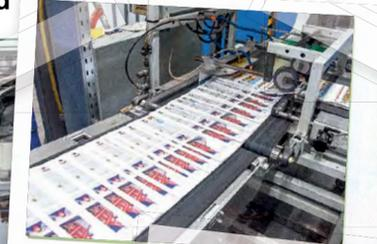
Die gedruckten Zeitungen werden über einen Rotationschneider einzeln. Nach dem Dreiseitenbeschnitt geht's auf dem Fließband Richtung Roboter, der alle Exemplare sortenrein für den Vertrieb auf Paletten stapelt.
