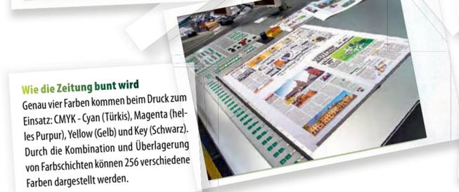
Die Papierbahn ist fertig bedruckt und nach Trocknung auf dem Weg zum Falzapparat. Alles geht rasend schnell: Pro Minute können über 600 Zeitungen in Ahrensfelde gedruckt und für den Versand vorbereitet werden.
