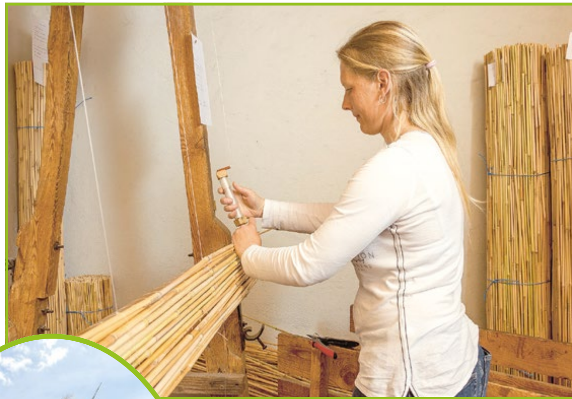
Rohrweberin Jenny Wagner verknötet jeden Stab per Hand.
